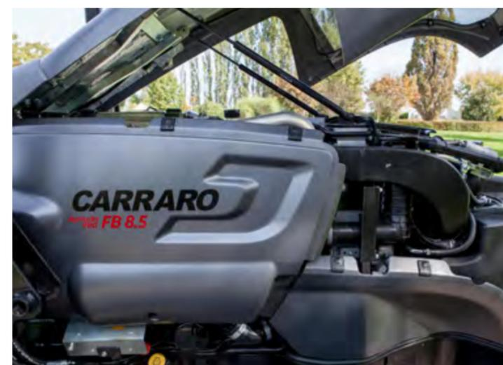
co modulo collocato sotto il cofano, in modo da ridurre ulteriormente gli ingombri e consentire all'operatore una perfetta visibilità. Le curve di potenza sviluppate per Carraro sono tre: 55kW (senza ADBLue), 67kW con ADBLue, 75kW con ADBLue.
